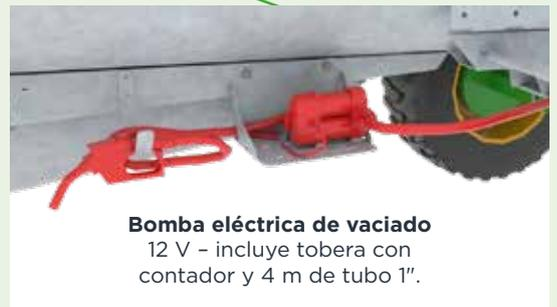
**Bomba eléctrica de vaciado** 12 V - incluye tobera con contador y 4 m de tubo 1".
