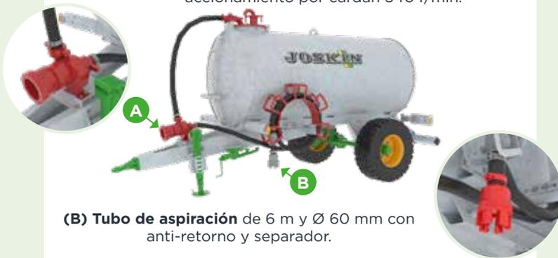
**(B) Tubo de aspiración** de 6 m y Ø 60 mm con anti-retorno y separador.
